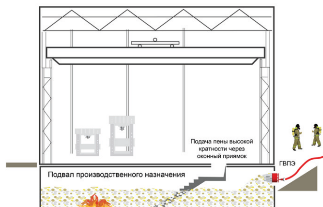
СХЕМА 3. Подача пены высокой кратности через оконный приямок в подвал производственного назначения
