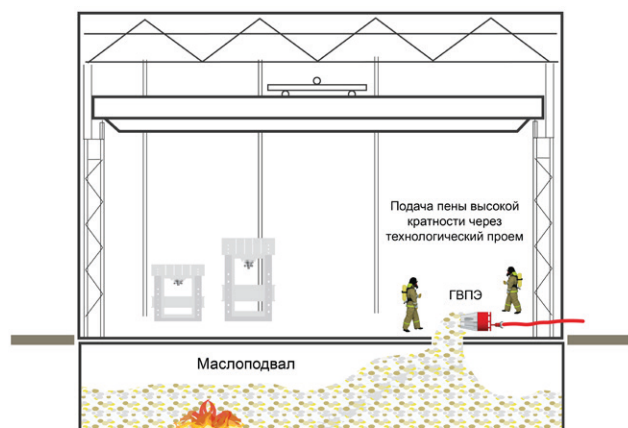
СХЕМА 2. Подача пены высокой кратности через технологический проем в маслоподвал
